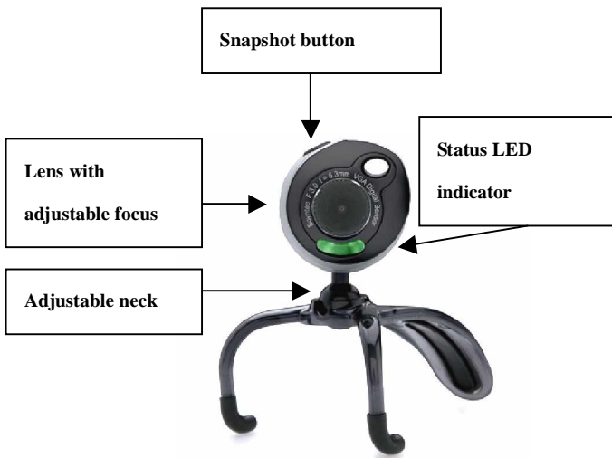
Figura A: Webcam main parts
