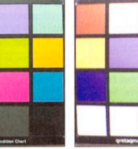
A la izquierda se aprecia que Logitech Quickcam Pro representa, con mucha mayor fidelidad, la carta de colores que empleamos en la prueba de calidad cromática que el modelo de Sointec.
